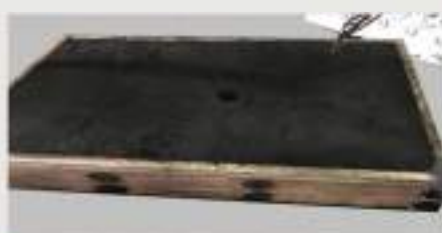
FERMETURE DES 2 DEMI MOULES EN SABLE
