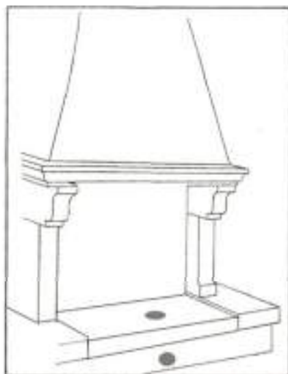
REALISATION D'UN TROU POUR ARRIVER D'AIR FRAIS diamètre environ 100mm
