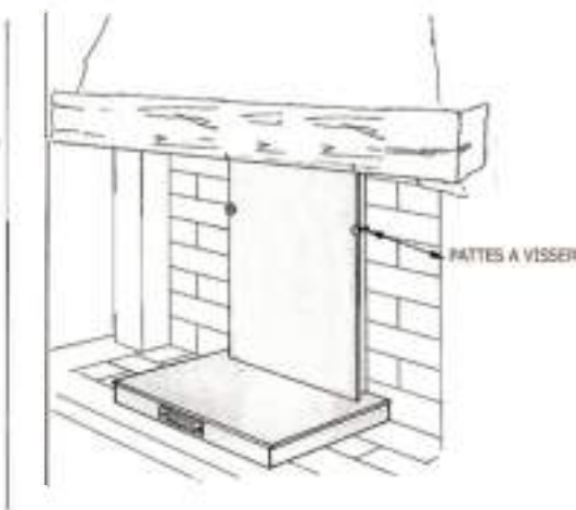
POSE DE LA PLAQUE VERTICAL SUR LA PLAQUE DE SOL AVEC FIXATION DE LA PLAQUE VERTICAL DANS LE MUR AVEC PATTES A VISSER
